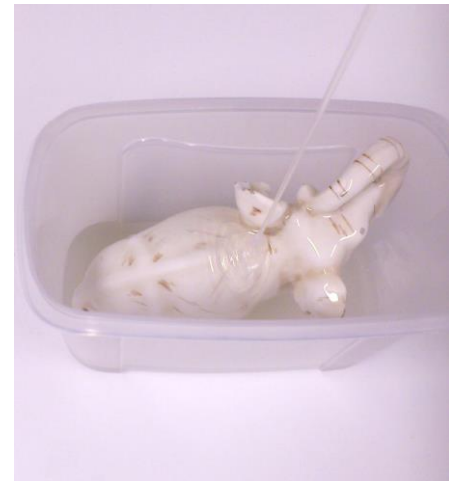
Fig. 3: Met een dunne straal worden de siliconen gegoten tot totdat de siliconen een cm boven de olifant uit komen.
