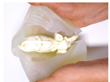
Fig. 4: De mal is aan de bovenkant (over de ruggengraat) van de olifant open gesneden zodat het kopie er uit getild kan worden.
