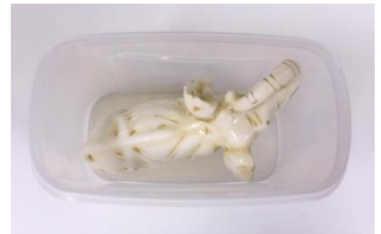
Fig. 2: Het model op plasticine balletjes in een bakje gedrukt, gepositioneerd en voorzien van een lossingspray.
